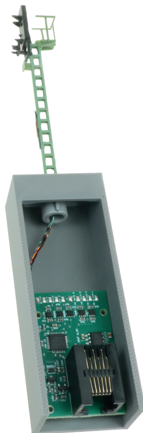
Decoder 63 430, eingebaut in einem Wattenscheider Schacht
