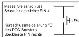
Solche Nothalt-Tasten können überall auf der Anlage platziert werden. Es können beliebig viele Taster parallel angeschlossen werden. Der Anschluss erfolgt laut obenstehendem Bild.
