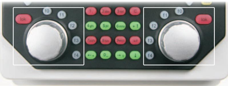
Jedes Fahrpult besteht aus dem Fahrreglerknopf zur Änderung von Lokgeschwindigkeit und Fahrtrichtung, sowie aus den Sonderfunktionstasten f0 bis f4. Die [lok]-Taste jedes Fahrpults dient dazu, eine neue Lok auf den Fahrregler zu übernehmen.
