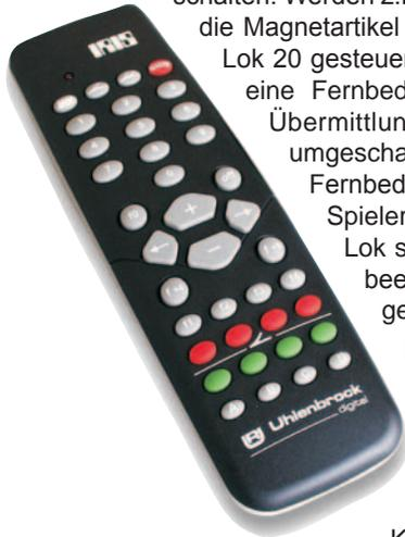
Die pro Kanal ausgewählten Adressen werden in der Intellibox II dauerhaft abgespeichert und stehen somit auch nach dem Aus- und wieder Einschalten zur Verfügung. Im Auslieferungszustand sind den Kanälen A, B, C und D die Lokadressen 1, 2, 3 und 4 zugeordnet. Die Magnetartikeltasten aller Kanäle schalten die Magnetartikeladressen 1 bis 4.
