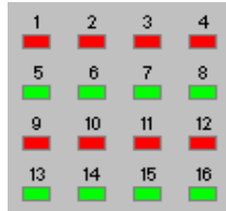
Bild 5.21 Das mittlere Tastenfeld mit der Nummerierung der Tastenpaare im s88 Modus.
