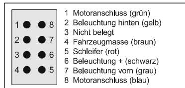
Bild 2.41 Belegung der NEM 652 Schnittstelle und die Märklin Kabelfarben
