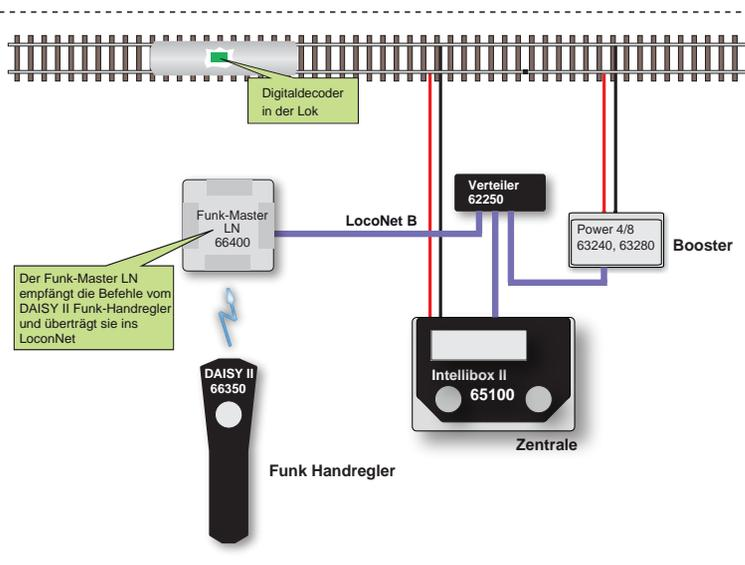
Auch der DAISY II-Funk-Handregler eignet sich zum Betrieb an allen Zentralen mit Loconet-Anschluss. Er kann direkt an das Loconet angesteckt werden, also kabelgebunden arbeiten, oder per Funk mit ei-
