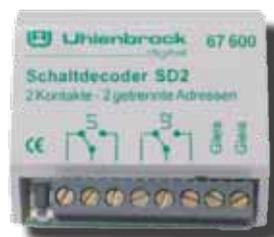
Universeller Schaltdecoder mit zwei potentialfreien Umschaltkontakten, die unter zwei Adressen unabhängig voneinander angesprochen werden können. Der Decoder schaltet unabhängig voneinander zwei verschiedene Verbraucher, beispielsweise Lampen oder motorische Weichenantriebe.
