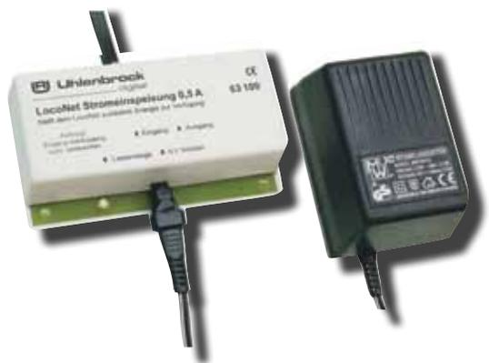
Wenn die gesamte Stromaufnahme der angeschlossenen LocoNet-Geräte größer ist als der maximale Ausgangsstrom der Zentrale, ist eine LocoNet-Stromeinspeisung erforderlich. Die Stromeinspeisung stellt dem LocoNet weitere 500 mA zur Verfügung. Sie kann an jeder Stelle im LocoNet eingefügt werden.
