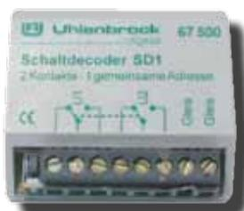
Universeller Schaltdecoder mit zwei getrennten, potentialfreien Umschaltkontakten, die unter einer Adresse gemeinsam angesprochen werden können. Ein Kontakt kann zum Beispiel ein Lichtsignal bedienen und der zweite die Fahrspannung schalten.
