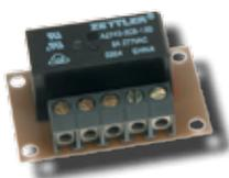
Zum Betrieb mehrerer Kehrschleifen können Sie bis zu sieben Kehrschleifenrelais an einen Power 4 oder Power 7 anschließen. Die Kehrschleifen können dann auch von den Rückmeldemodulen 63 320 oder 63 340 einzeln überwacht werden.
