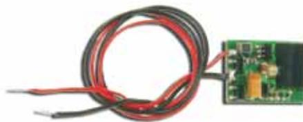
Jedes Fahrzeug, das eine automatische Steuerungsfunktion ausführen soll, erhält einen LISSY-Infrarotsender. Das Modul sendet Adressen im Bereich 1–16382 und vier Zugkategorien aus. Etwa ICE, Personenzug oder Güterzug.
