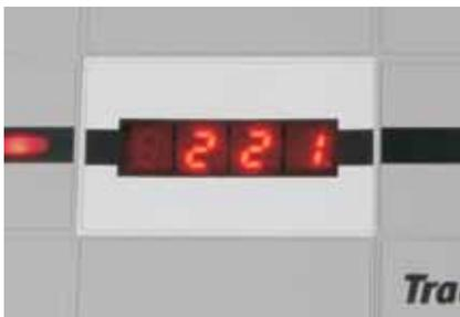
Bei Einsatz des Lok-individuellen Steuerungssystems LISSY werden die Zugnummern der Züge angezeigt, die den zugeordneten Sensor des LISSY-Systems (z. B. am Ausfahrgeleis des Schattenbahnhofs) passieren.
