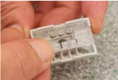
**3. Drehen Sie** die Segmente um. Legen Sie die Streuscheiben, falls benötigt die Tastenkappen, und die Platinen in die Segmente.
