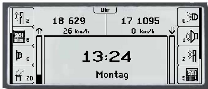
Voraussetzung für Fahrplanfahrten ist eine Modellzeituhr. Die Intellibox® II besitzt diese Modellzeituhr, die im Display eingeblendet werden kann. Sie zeigt die Uhrzeit und den Wochentag an. Diese Modellzeit kann zur Normalzeit um Faktoren zwischen 1 und 127 beschleunigt werden. Die Uhr der Intellibox® II ist darüber hinaus auch in der Lage an das LocoNet angeschlossene Uhren zu synchronisieren.
