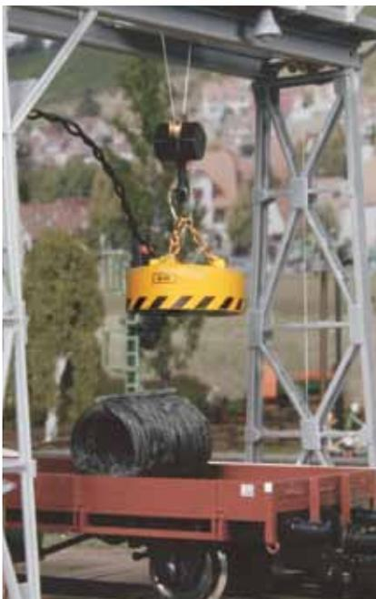
Modell des Lasthebemagneten BvM L34-170 der Firma J. Braun GmbH.
